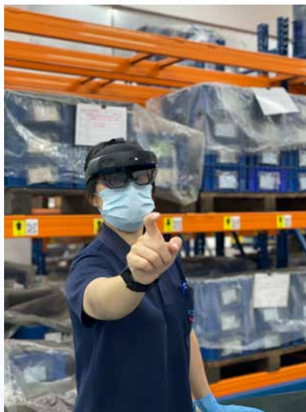
圖（上）：員工戴上MR眼鏡確認工單內容並依指引前往原料位置進行撿料，透過AI辨識自動記錄，節省員工Key In時間，並有效降低人工失誤成本。
