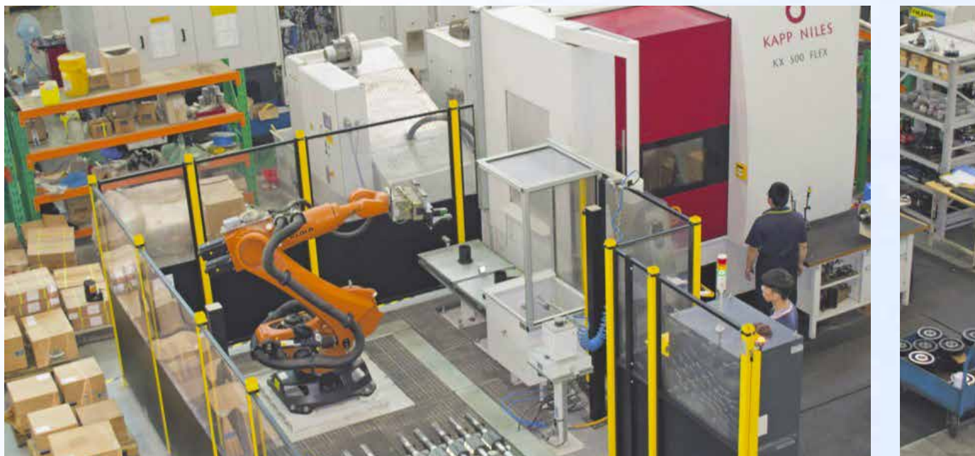
圖（上）：三隆齒輪應用AI技術在機台上安裝傳感器，即時監控設備運行狀態，透過發現數據模型異常提前示警，成功讓機台維護成本下降10-15%，且減少超過10%的停機率。
